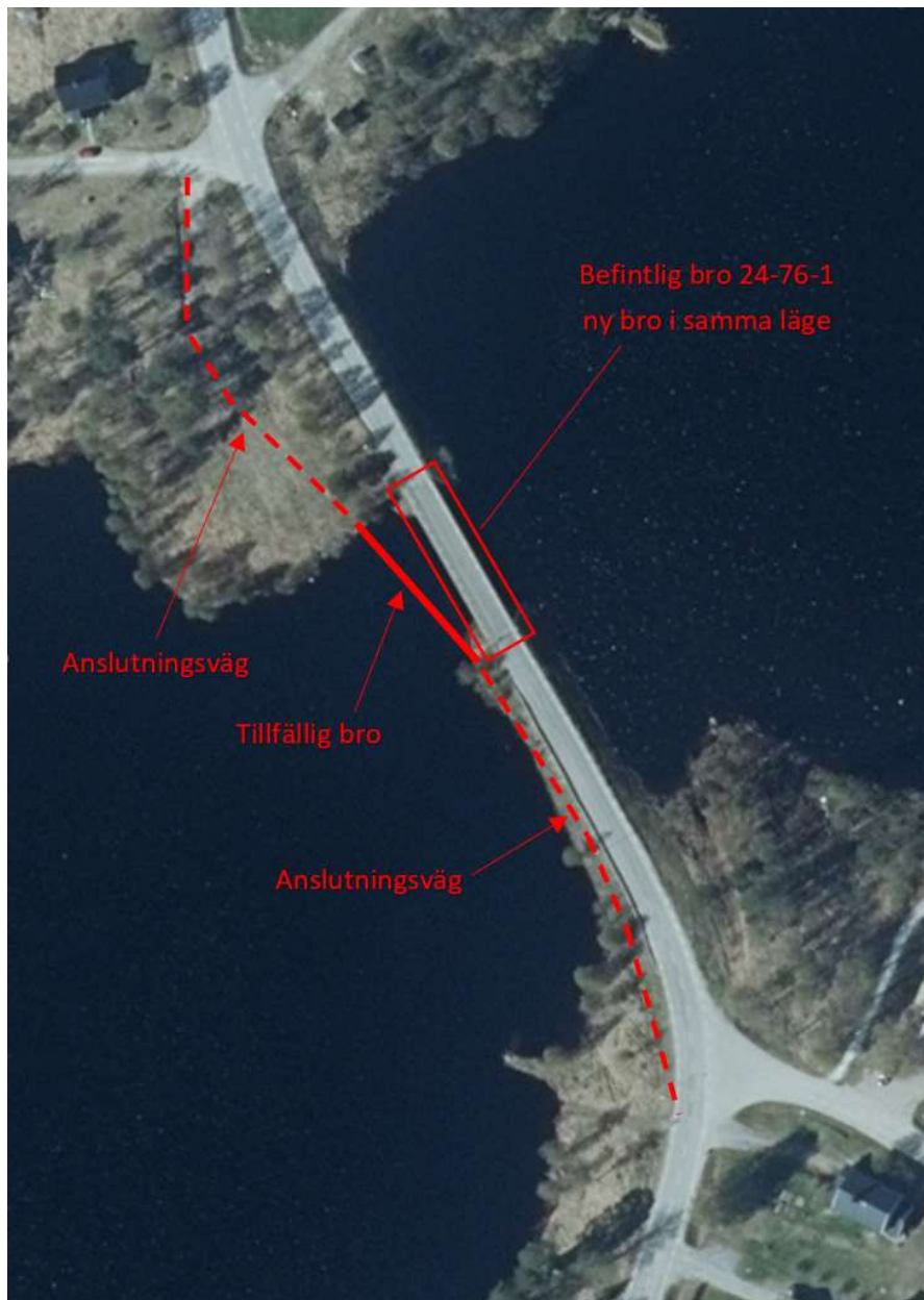
Figur 10. Planöversikt, föreslaget läge för tillfällig bro med tillfälliga anslutningsvägar. Flygbild: ©Lantmäteriets "Min karta".
