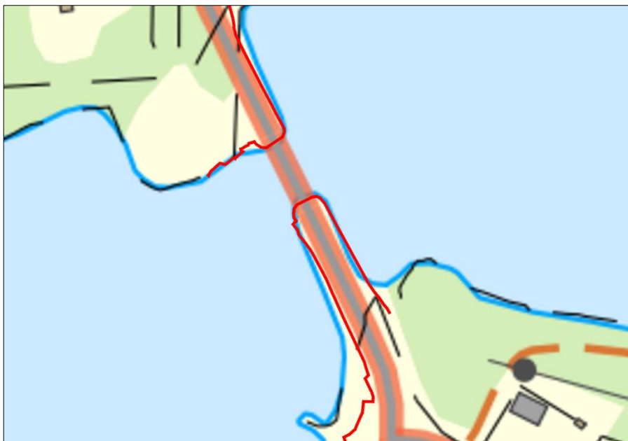
Figur 8. Utbredning av högsta högvatten (HHW100) i anslutning till bron markerad med röd linje.
